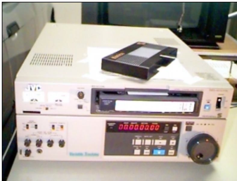
Abbildung 5: Die Zeitlupen/Zeitraffermaschine JVC BRS-525-E verwendet konventionelle SVHS- oder VHS-Videobänder. „Variable Tracking“ - Technologie (Lesekopfnachführung) und digitale Rauschunterdrückung ermöglichen beste Bildqualität bei jeder Abspielgeschwindigkeit (in 52 Stufen regelbar). Das Gerät kann über RS422-Schnittstelle ferngesteuert werden (38400 bps Vollduplex), das Protokoll ist dem Service Manual zu entnehmen. Zum Betrieb am PC hat sich ein handelsüblicher RS422-RS232-Konverter bewährt, es gibt aber auch RS422-Karten für PC.
