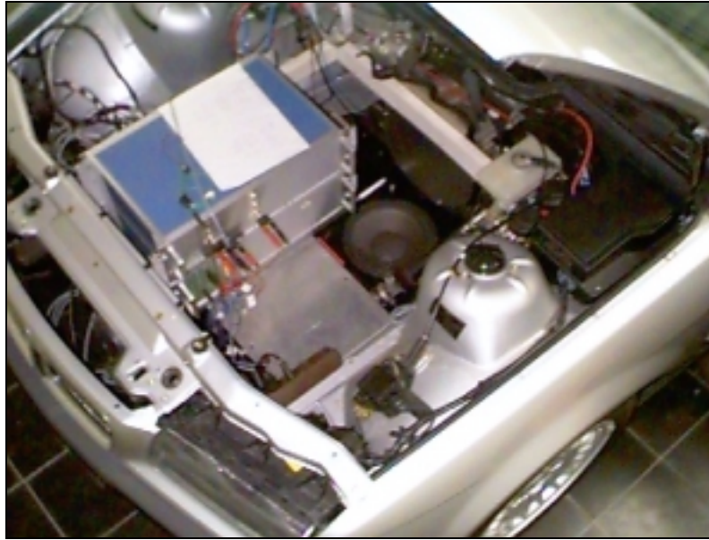
Abbildung 7: Der „Motorraum“, links oben Schaltungen für Meßdatenvorverarbeitung und Tachometeransteuerung, in der Mitte die Lautsprecherbox für die Fahrgeräuschsimulation.
