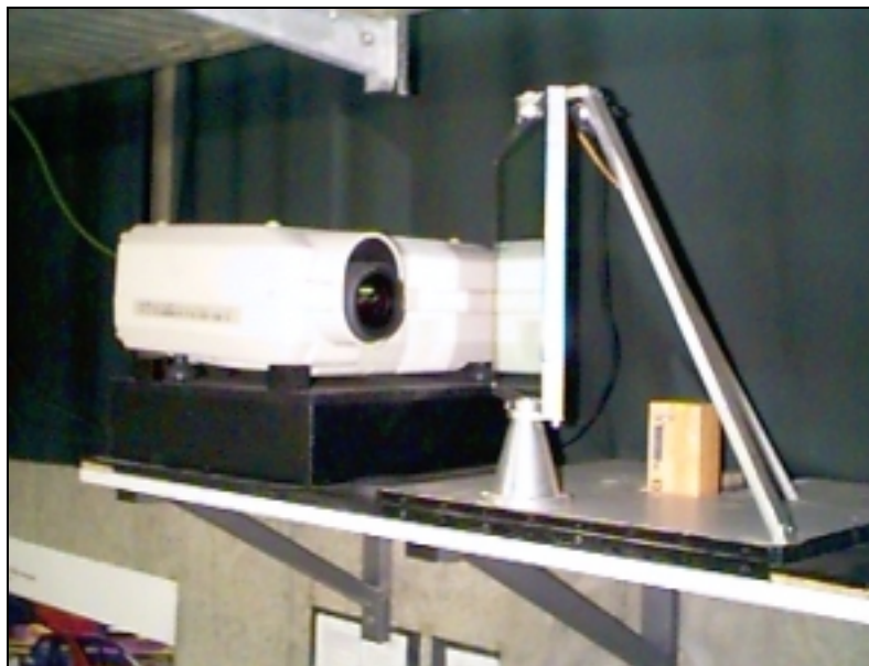
Abbildung 6: Videoprojektor und Schwenkspiegel. Die Projektion erfolgt übrigens nicht seitenverkehrt, denn wie fast alle Videoprojektoren verfügt das abgebildete Gerät über die Option, spiegelverkehrt zu projizieren.
